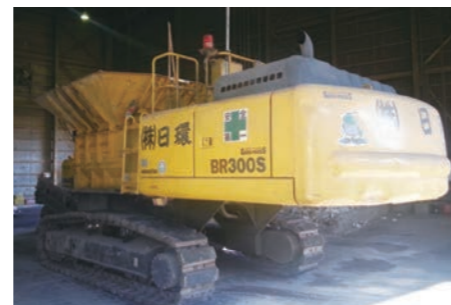
移動式破碎施設(二軸破碎機)
